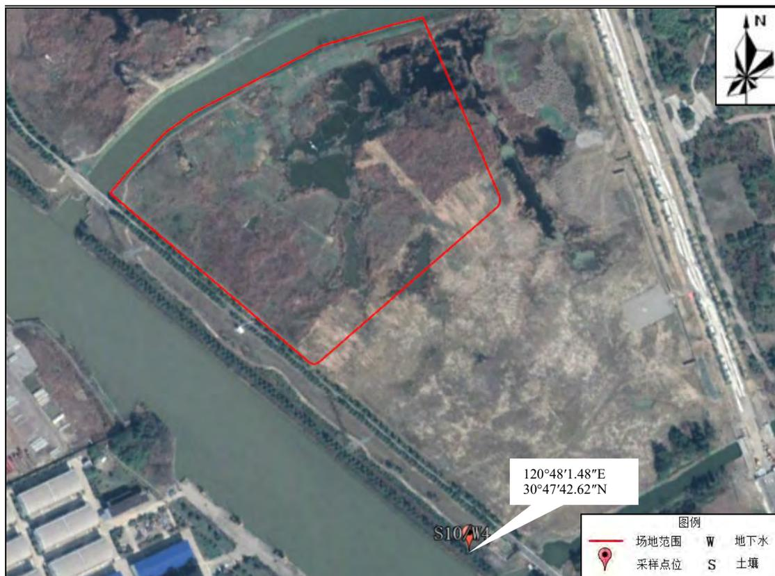
图 4.2-4 本次地块调查土壤及地下水采样点位布设图（地块外，含经纬度）
