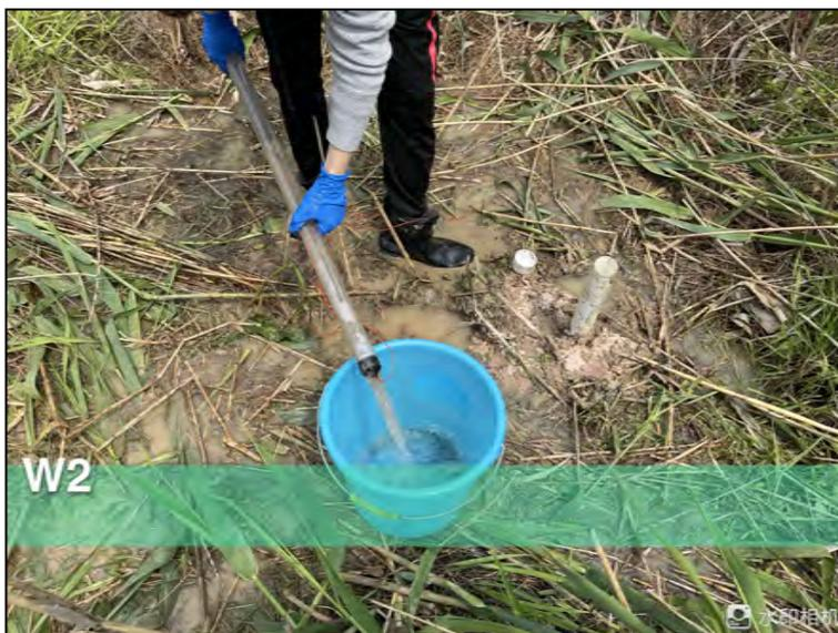
图 5.2-8 采样前洗井现场照片
